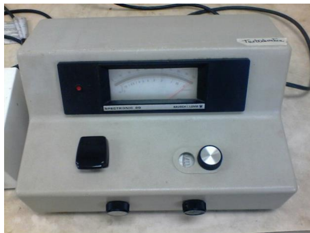
Figura 3.5. Turbidímetro. Laboratorio de Química Instrumental, U.C.V.
