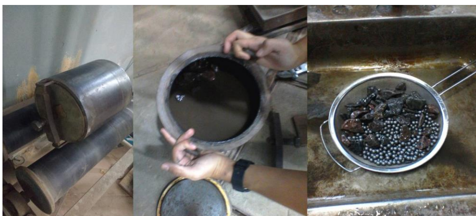
Figura 3.17. Proceso del ensayo Micro Deval
