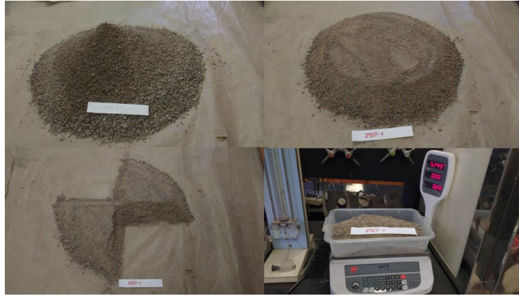
Figura 3.8. Cuarteo y pesado de la muestra 2427-1
