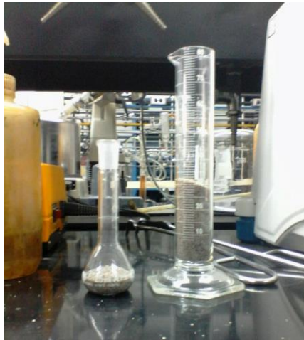
Figura 3.13. Procedimiento para determinar la densidad bulk
