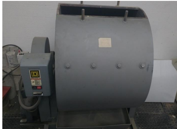
Figura 3.4. Máquina de los Ángeles. Laboratorio de Mecánica de Rocas, U.C.V.
