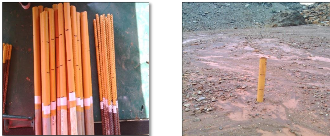
Figura 3. 9 Varillas utilizadas para mediciones de los procesos de erosión y sedimentación C.V.M. S.A. División-Níquel. Fotografía tomada por José Cova (2016).
