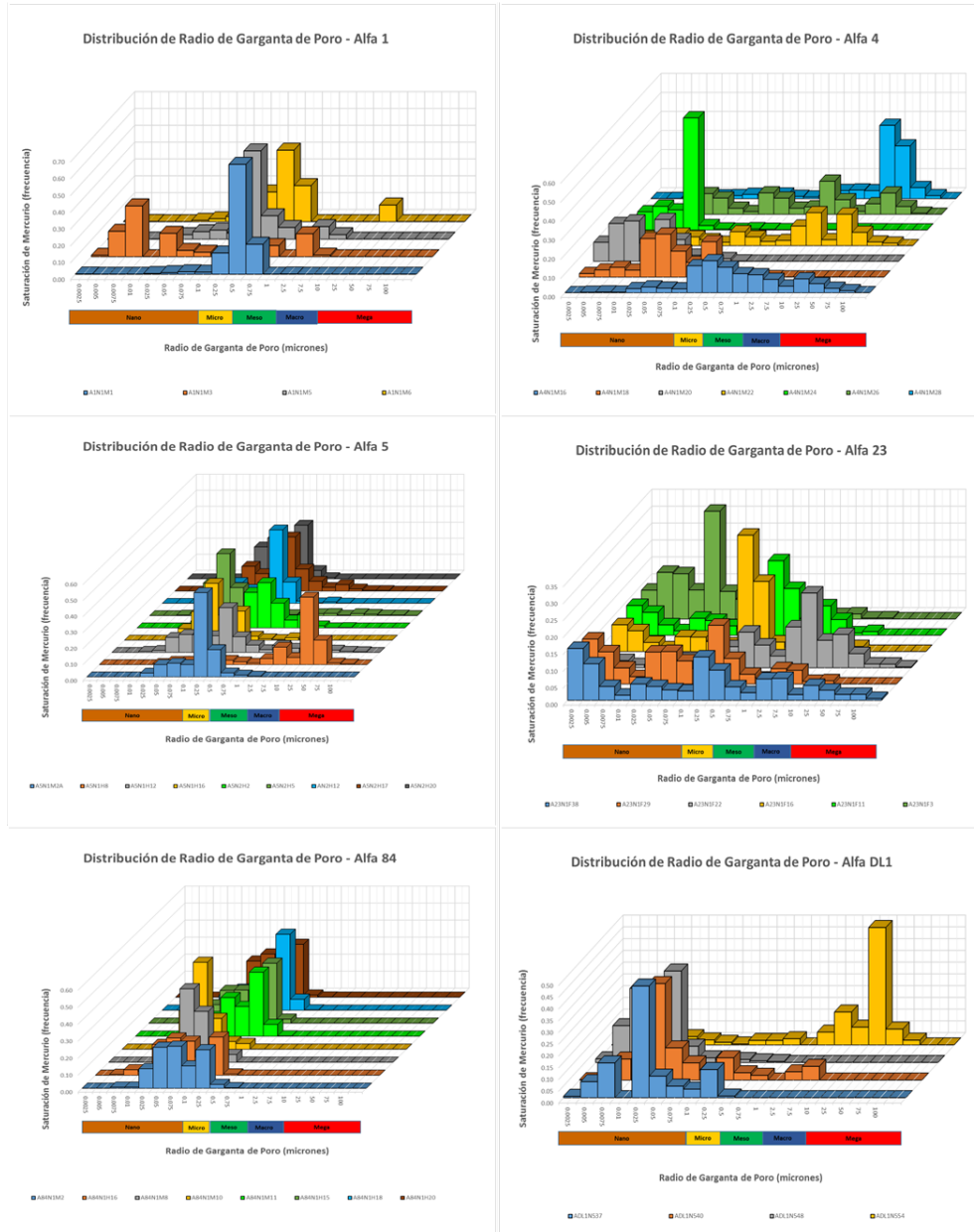
Figura 24. Gráfico de distribución de radio de la garganta de poro de las muestras de núcleos de los pozos Alfa-1,4, 5, 23, 84 y DL1.
