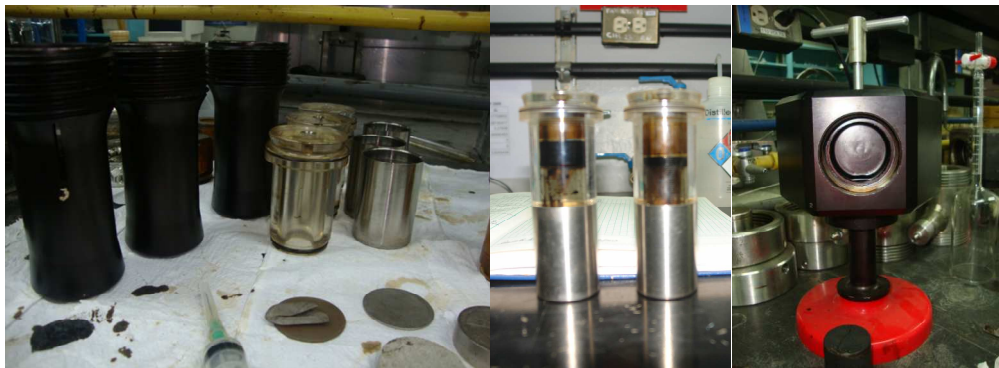
Figura 47. Celdas de imbibición para acoplar a rotor de Ultracentrífuga, para alcanzar Sor y medir V_{od} .
