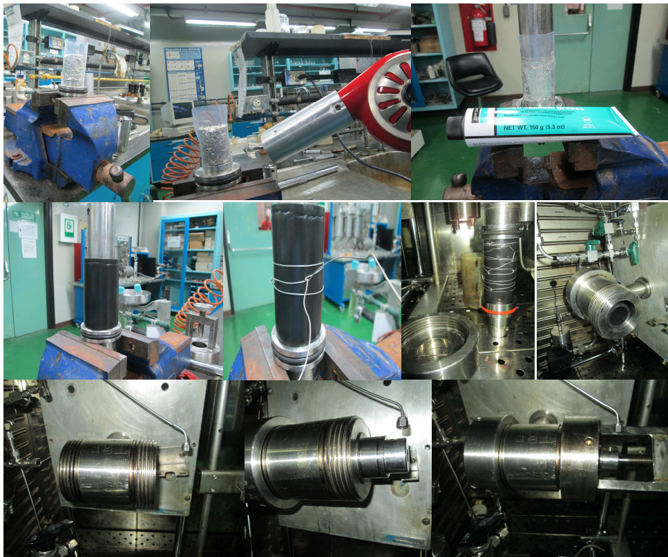
Figura 53. Secuencia de empaquetamiento de la muestra, aseguramiento de la manga y colocación en la celda de desplazamiento.
