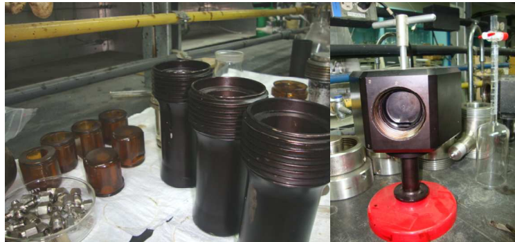
Figura 44. Diseño para drenaje forzado de crudo en el núcleo hasta S_{wi} ( V_{wd} ).
