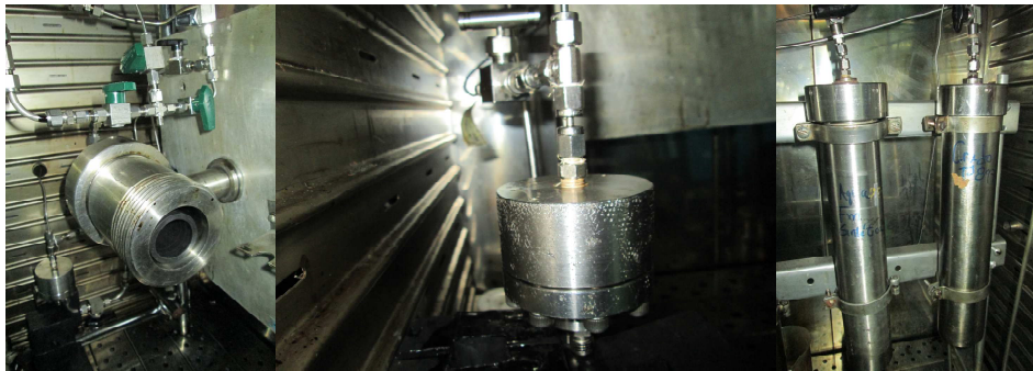
Figura 54: Válvula de contra presión y pistones dentro del horno
