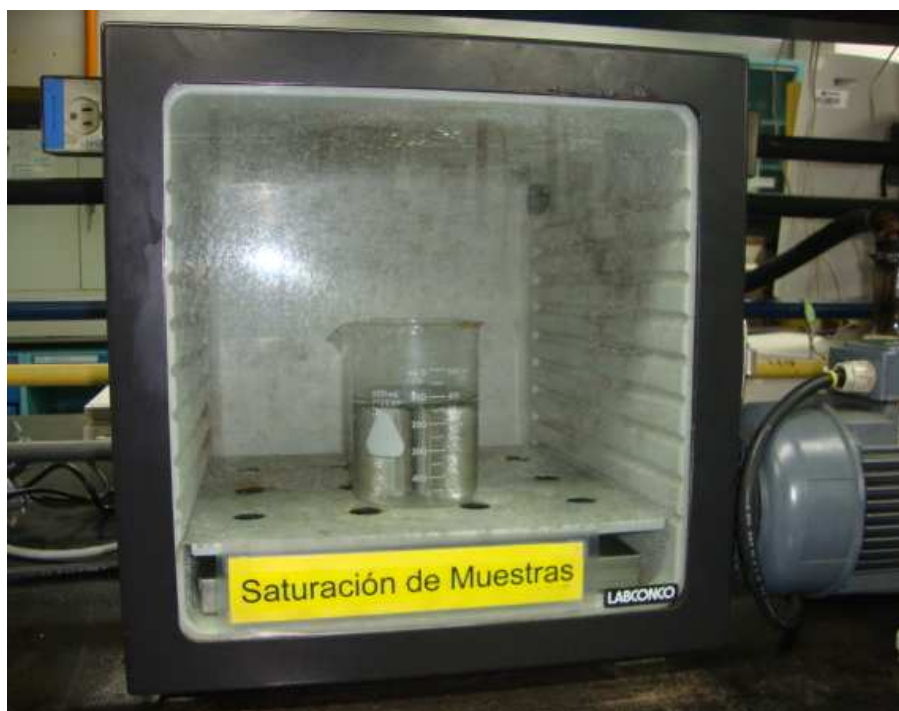
Figura 43. Núcleos sometidos a saturación al vacío en agua de formación
