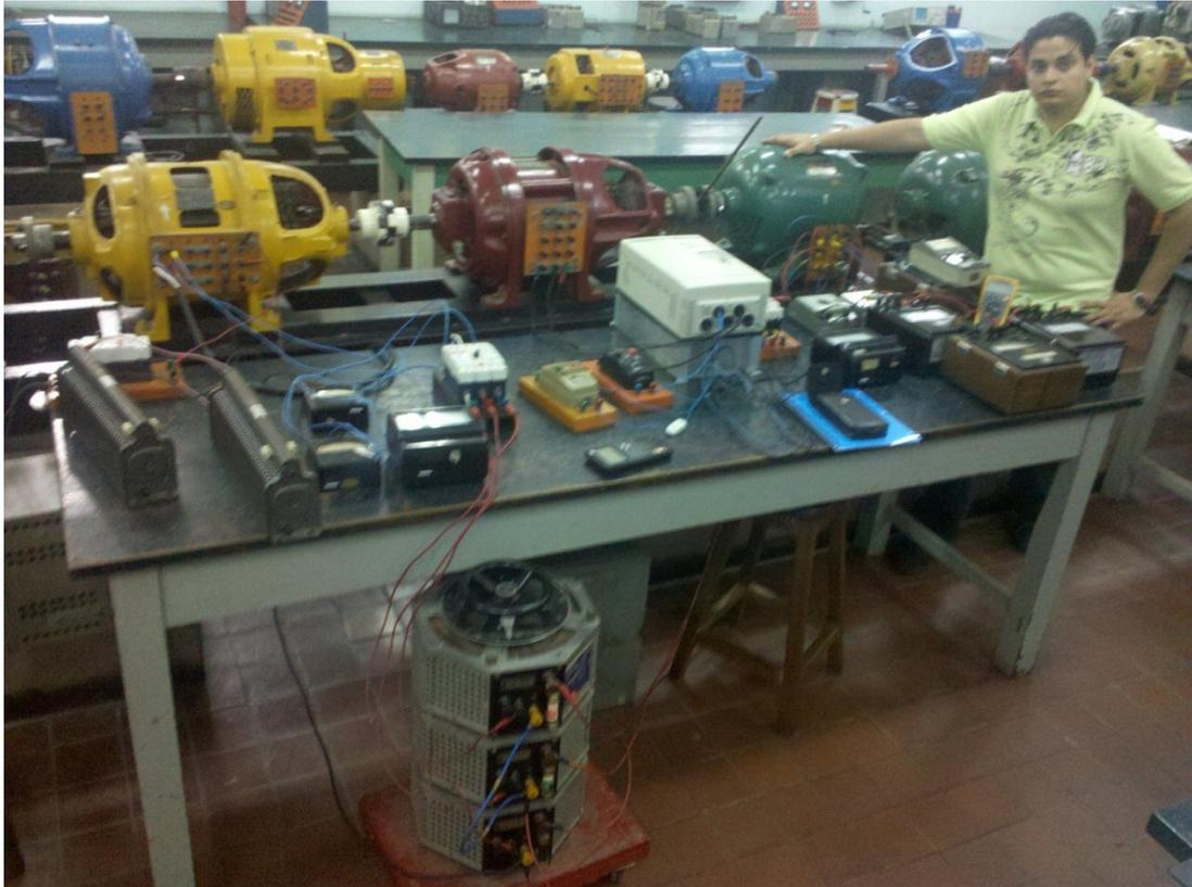
*Figura D.2.* Prueba de rotor bloqueado a frecuencia reducida en el motor jaula de ardilla (verde, banco 3).
