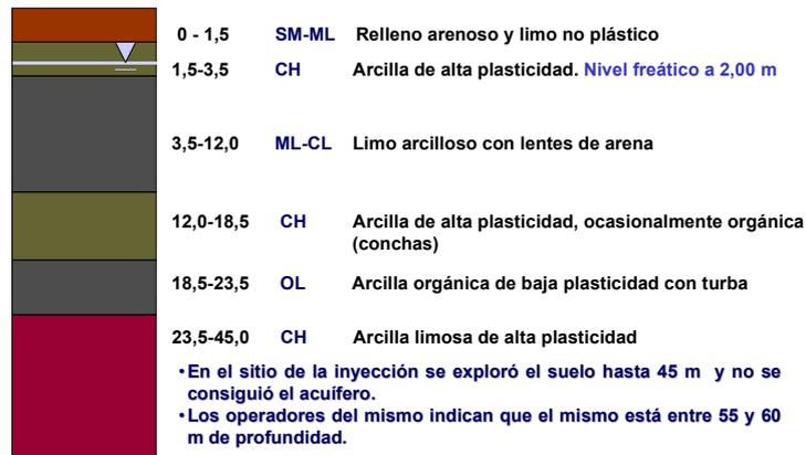
Figura (3.7) Perfil geotécnico en el sitio de prueba de San Lorenzo
