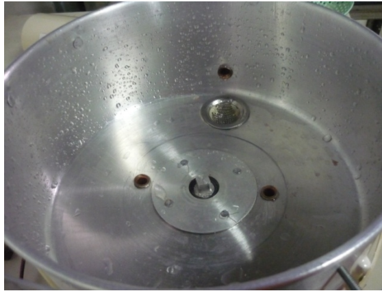
Figura A 11.10. Vista de la olla y los agujeros de entrada y salida del agua.
