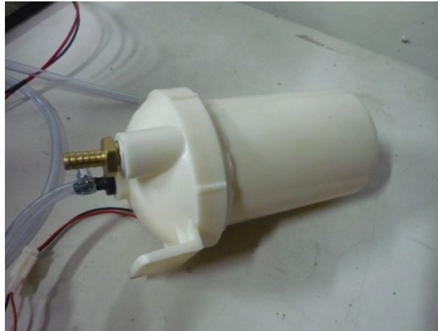
Figura A 11.7. Filtro de carbón activado.
