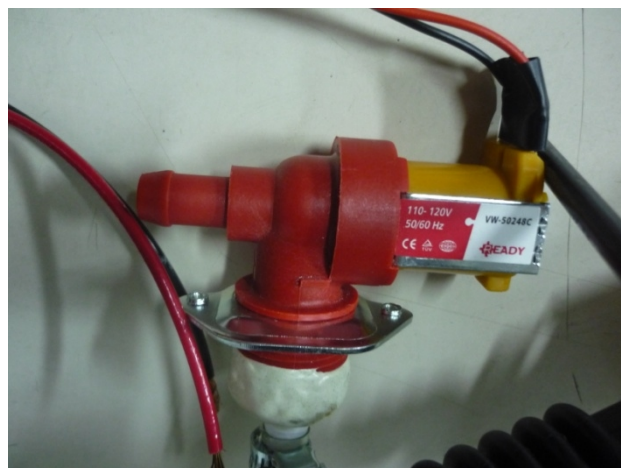
Figura A 11.6. Válvula solenoide de la bomba de desagüe.
