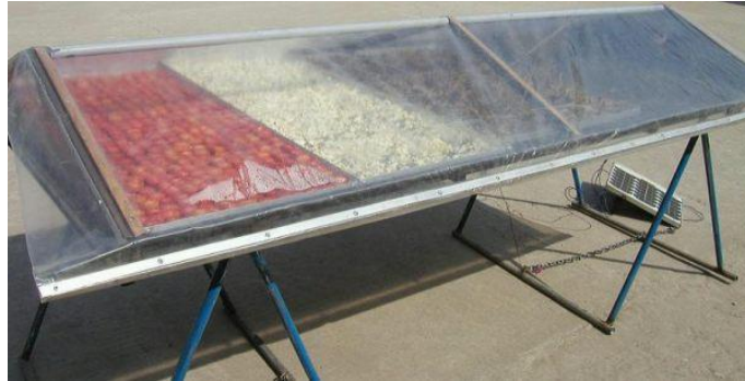
Figura 2.11. Secador solar directo
