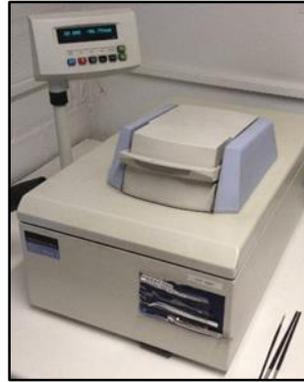
Figura 3.9 DSC (equipo utilizado)
