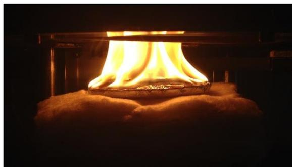
Figura 3.12 Ensayo en cono calorimétrico. PVA,  $\text{CaCO}_3$ , montmorillonita y grafeno
