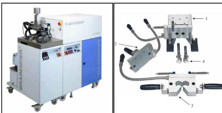
*Figura 3.3 Estación de mezclado Brabender. 1) Soporte de amasadora con mecanismo y pared dorsal de la amasadora 2) Parte delantera desmontable de la amasadora 3) Cámara de amasado desmontable 4) Paletas de la amasadora. (Cornement, 2006)*
