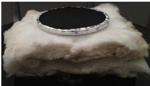
*Figura 3.13 Disco sólido preparado para ensayo en cono calorimétrico*
