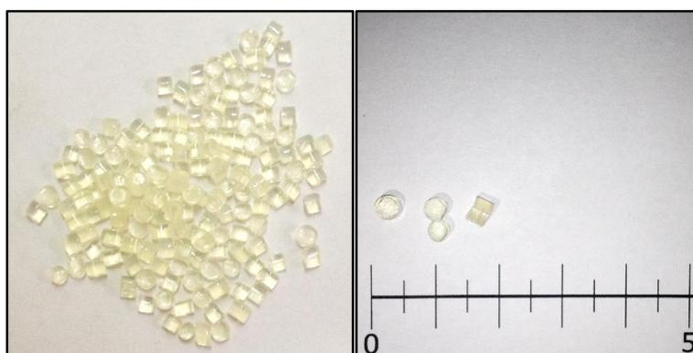
Figura 2.2 Granza o pellets de PVA. (Escala en centímetros)
