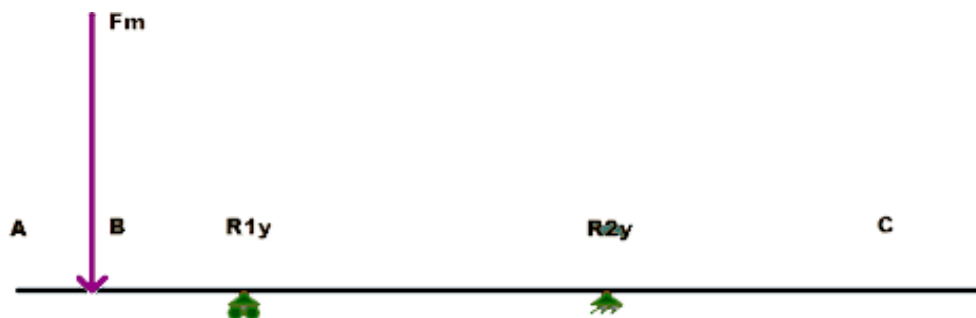
Imagen 41. Proyección del árbol conducido de discos de corte en el plano XY. Fuente: Los autores.
