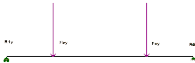
Imagen 37. Proyección del árbol conducido de sujeción en el plano XY. Fuente: Los autores.
