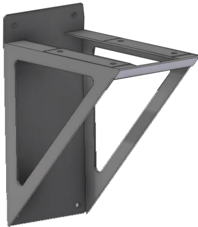
Imagen 51. Base de los motor-reductores. Fuente: Los autores.
