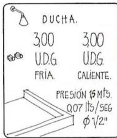
Imagen 55. Datos de una ducha, para el cálculo de tuberías. Fuente: López, Luis. AGUA Instalaciones Sanitarias en los edificios.1990.
