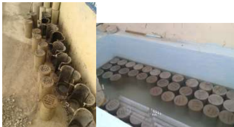
Fig.2 Desencofrado y curado de probetas
