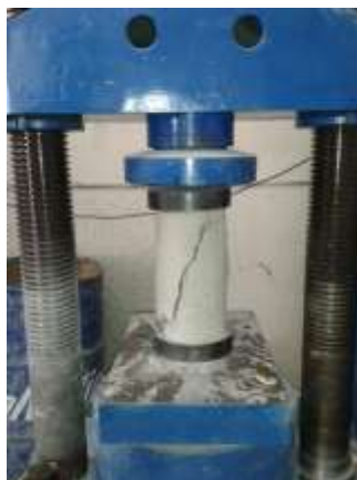
Fig. 3 Ensayo a compresión de probetas.
