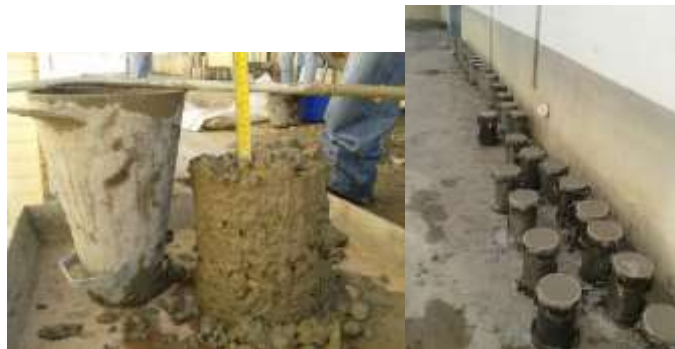
Fig. 1 Asentamiento del concreto y probetas
