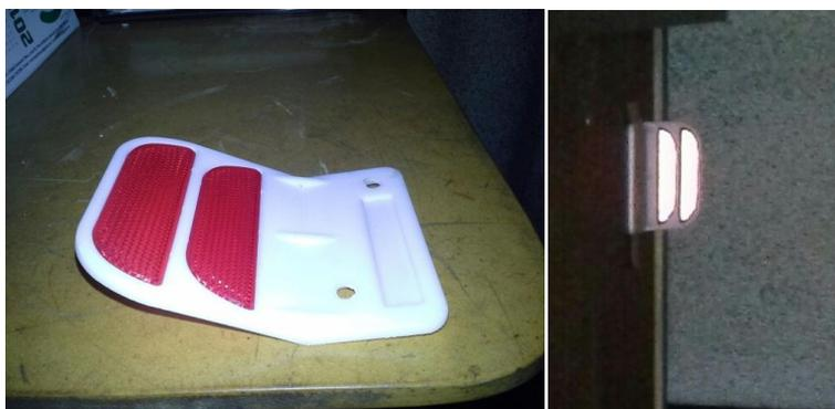
Figura 40: Prototipo del delineador de barandillas donde se muestra la retrorreflexión
