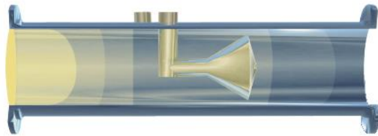
Figura 6. Perfil de velocidad modificado por el medidor de flujo volumétrico tipo cono
