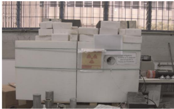
Figura 4.1. Vista de la fuente de neutrones de la USB con el blindaje biológico externo.
