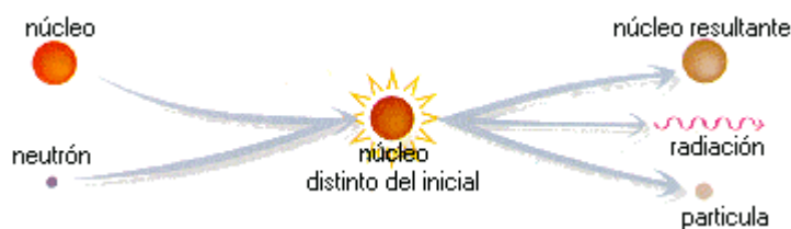
Figura 3.1. Esquema de reacción nuclear. Fisicanet (2000).
