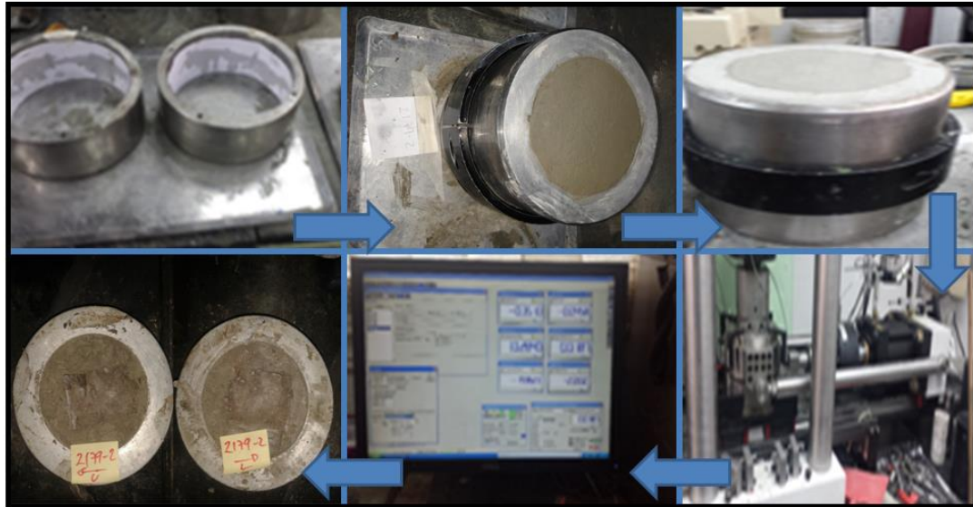
Figura 3.6 .Procedimiento para el ensayo de corte directo
