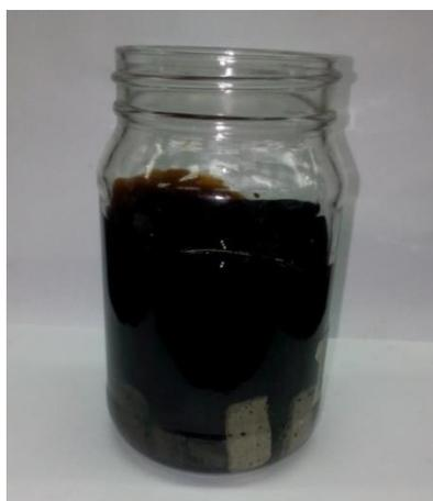
**Figura 3.5.** Placas de berea en un sistema crudo/agua de formación.
