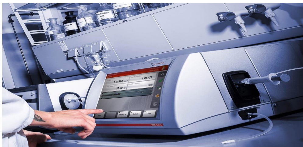
Figura 4. 5. Densímetro Anton Paar D 4500 M
