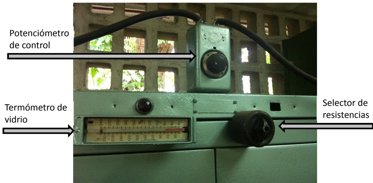
Figura 8. Detalle de los elementos de control de la Estufa N°. 2.
