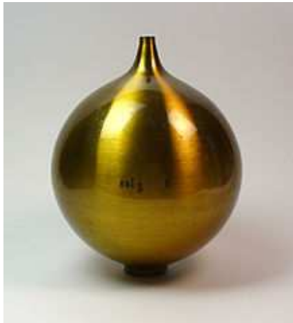
Figura 2.30: Resonador de Helmholtz (Fuente: Departamento de Física. Universidad Case de Western Reserve)
