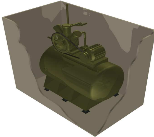
Figura 5.5: Isometría del compresor Ingersoll Rand, con la cámara de absorción colocada. Se pueden apreciar en detalle, los tacones de neopreno puestos en las bases de la máquina
