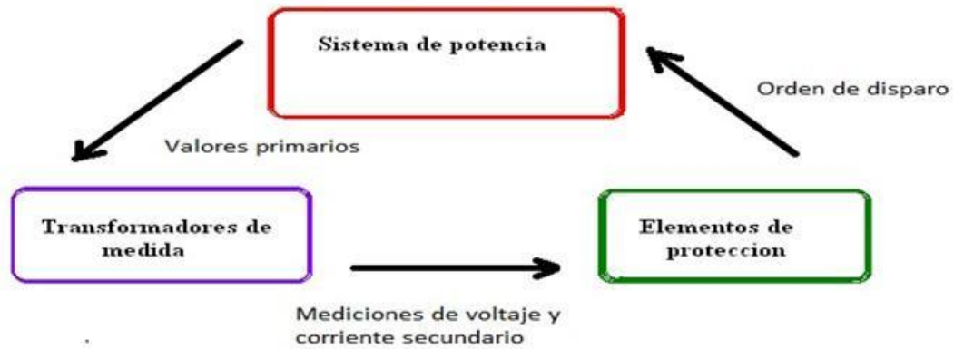
Figura 8: Esquema del sistema de protecciones
