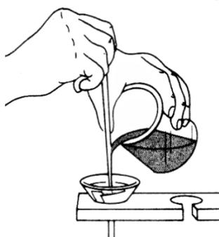
Figura 20. Vertido controlado de una solución usando una barra de vidrio
