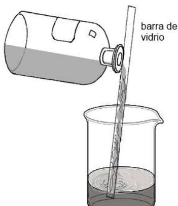
Figura 13. Una barra de vidrio permite un vertido controlado y sin salpicaduras. La barra debe tocar la pared interna del vaso.
