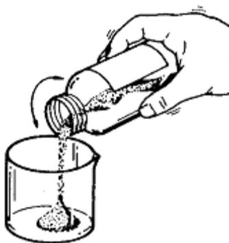
Figura 12. Vertido de un sólido rotando el recipiente en una y otra dirección.
