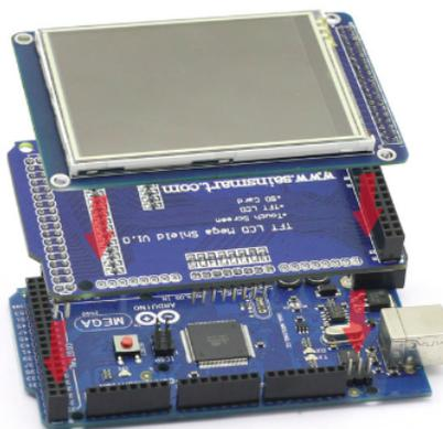
Figura 3.6: Conexión de pantalla LCD mediante placa adaptadora
