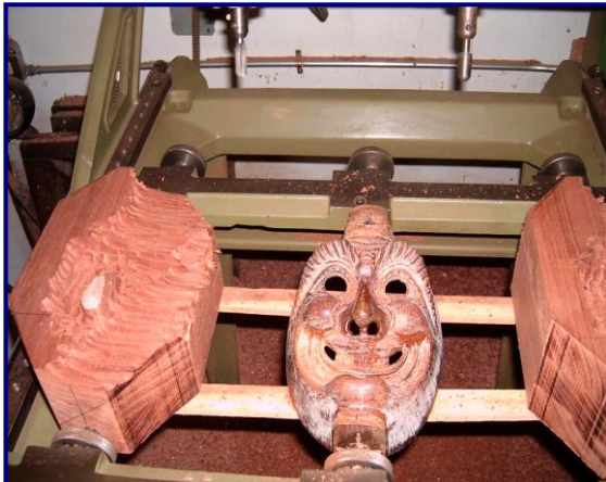
Fotografía 2. Fabricación de la máscara en pantógrafo
