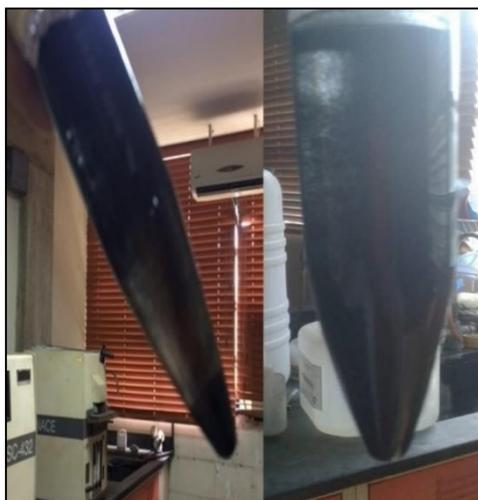
Figura 30. Separación tras centrifugación. Izquierda: Fracción depositada inertinita de Formación Marcelina. Derecha: No se observa claramente la separación, casi todo el material se deposita al intentar separar carbón de la Formación Matatere
