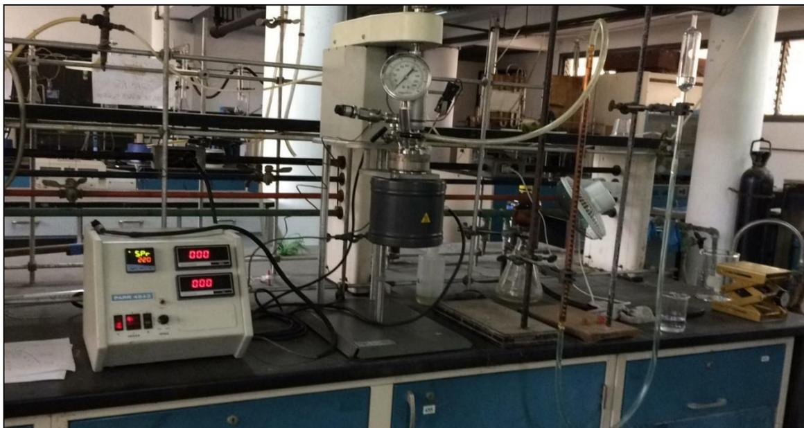
*Figura 20. Montaje para desorción de gases empleando reactor de calentamiento*
