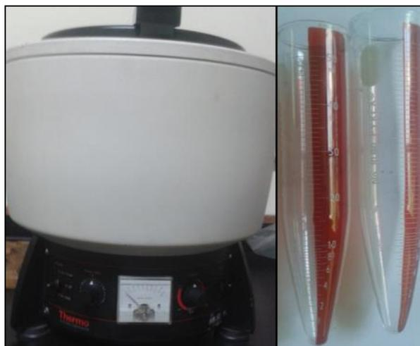
*Figura 19. Modelo de Centrifuga empleada por la investigación para CG (izquierda); tubos de centrifuga de vidrio (derecha)*
