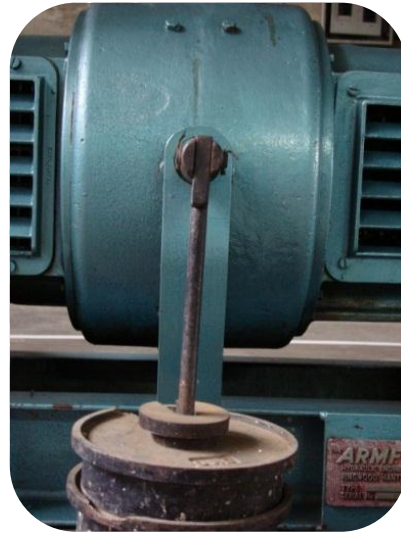
Foto. 9. Mecanismo empleado para medir el par del motor.
