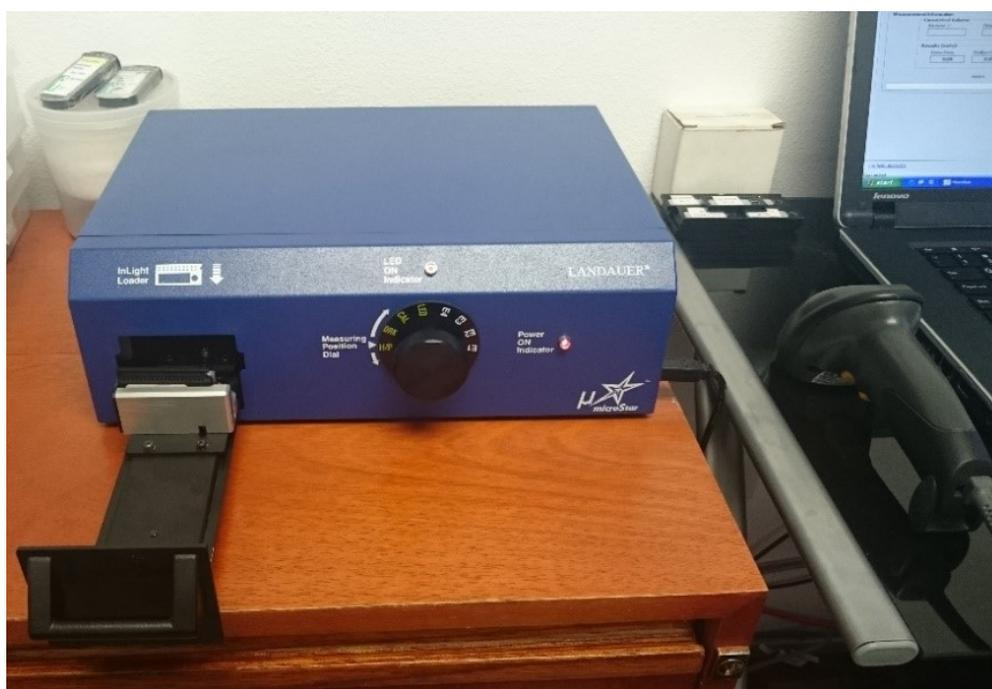
**Figura 5.11:** Lector microStar ubicado en las instalaciones de Física Médica C.A., con lector de código de barras.
