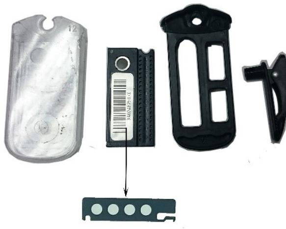
**Figura 5.4:** Modelo de dosímetro InLight® empleado, con la flecha se señala la tableta que contiene los cristales OSL.
