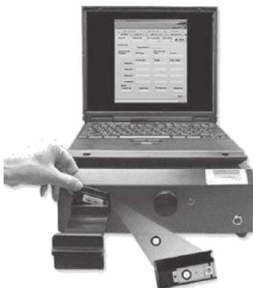
Figura 4.10: Lector InLight®, del fabricante LANDAUER® (19).
