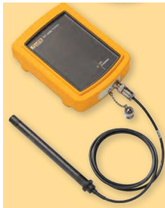
Figura 53: Imagen de Referencia para Sistema de Dosimetría en TC FLUKE
