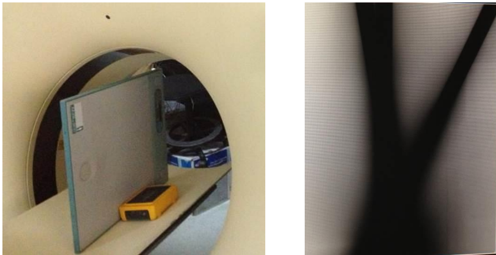
Figura 50: Imagen de Referencia para Angulación del Gantry e Imagen Radiológica Correspondiente
