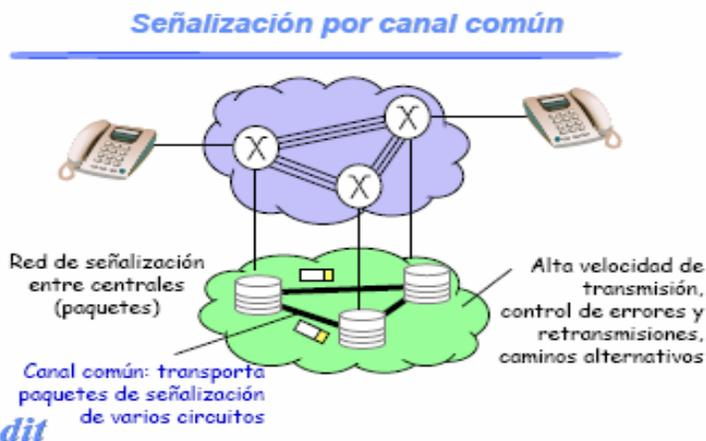
**Figura 14: Diagrama de señalización por canal común.**
