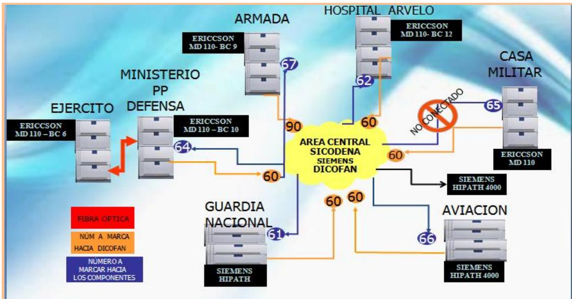
Figure 25: Diagrama de la interconexión de las centrales telefónicas de los componentes de la FANB y dígitos de identificación por componente.
