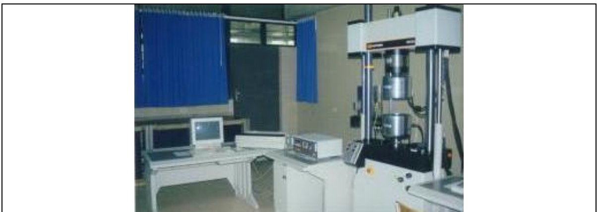
FIGURA 24. Máquina de ensayos universales Instron 8502.
