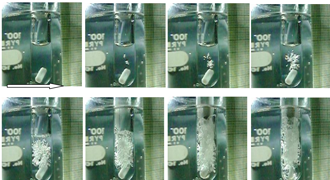
Figura 6.2.1. Imágenes fotográficas secuenciales de la formación del hidrogel de PAAm/15ppm \text{AgNO}_3 por iniciación química, donde se observa la formación de los macroporos y la evaporación del solvente.
