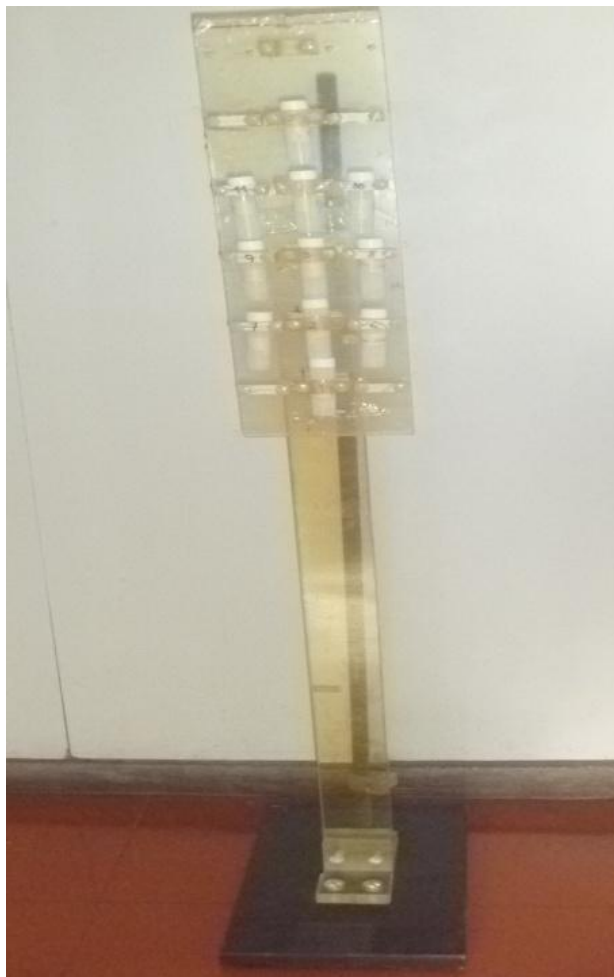
Figura A.1. Imagen fotográfica del soporte para irradiar 15 muestras simultáneamente, diseñado con bajos especificaciones del la mini fuente de irradiación utilizada.
