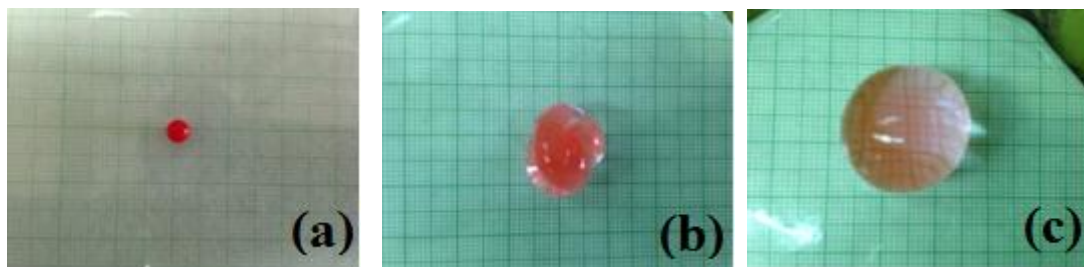
Figura 2.1.1. Polímero comercial usado como sustituto de suelos, a) xerogel a t=0 min con 0 %S, b) hidrogel a t = 60 min de hinchamiento con 6157 %S, c) hidrogel a 240 min de hinchamiento con 9228 %S. Como se observa el hinchamiento no es isotrópico en el tiempo (imagen b), pero al final del hinchamiento se mantiene la forma inicial del xerogel.
