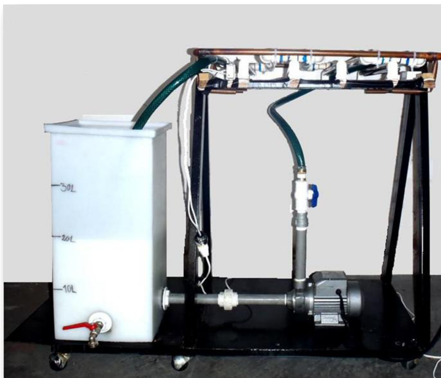
Figura 3-5. Fotografía del reactor solar empleado en las pruebas fotocatalíticas a escala banco.
