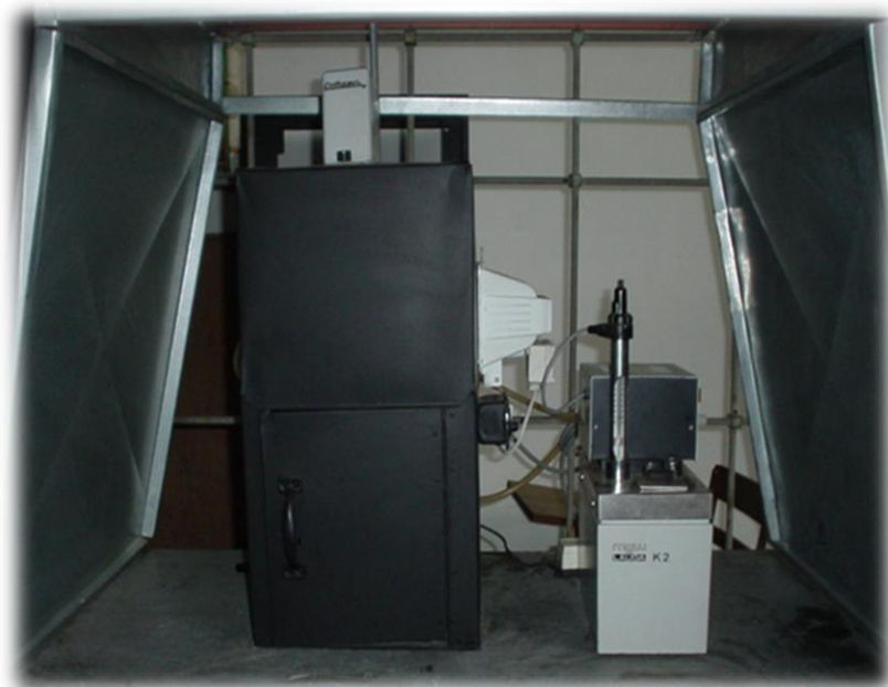
Figura 3-3. Fotografía del simulador solar empleado para las pruebas catalíticas.
