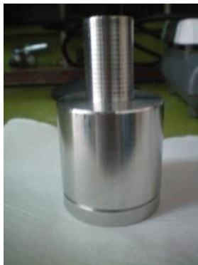
Figura 11. Troquel cilíndrico de acero
