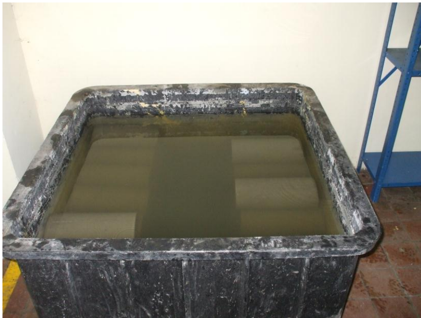
Figura N °23 Proceso de curado (IMME)
