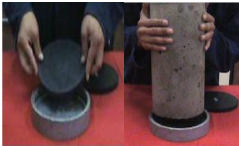
Figura N°7: Gomas de neopreno, plato retenedor y cilindro. (Fuente: Vidal, 2004)
