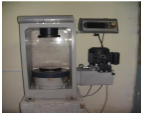
Figura N °13: Maquina Universal de Compresión.
