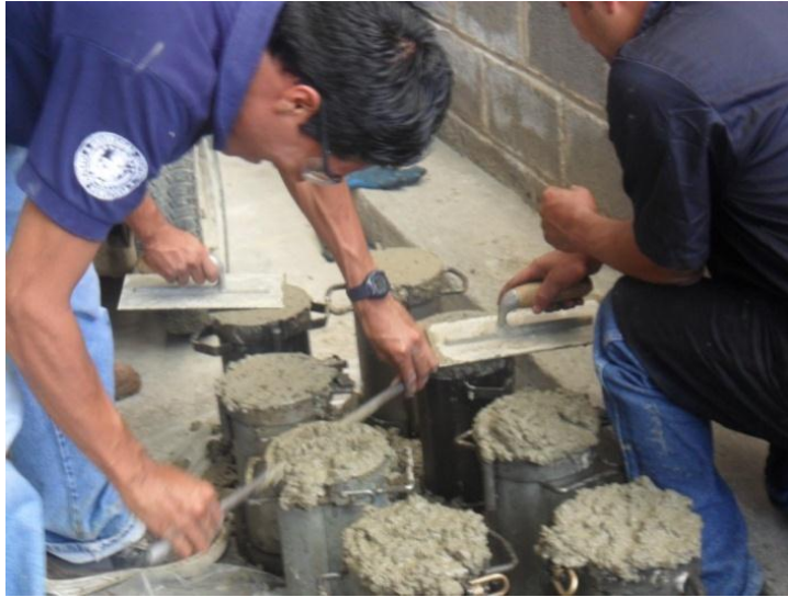
Figura N°10: Enrase de las probetas.
