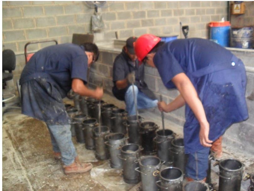
Figura N°20: Método de compactación por barra.(FNC)
