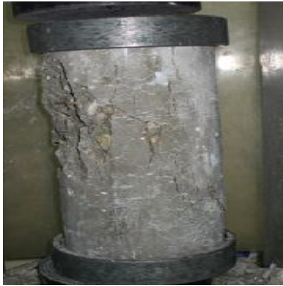
Figura N°14: Cilindro fracturado, fractura tipo 1.
