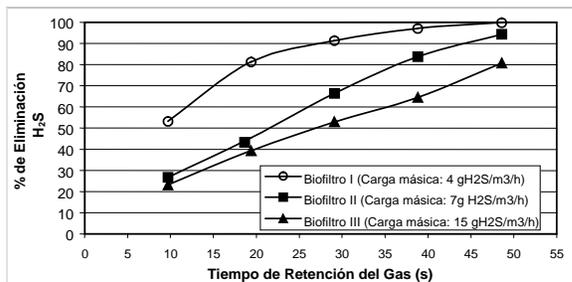
**Figura 1.** Eliminación de H<sub>2</sub>S en función del tiempo de retención para diferentes cargas másicas en los biofiltros.
