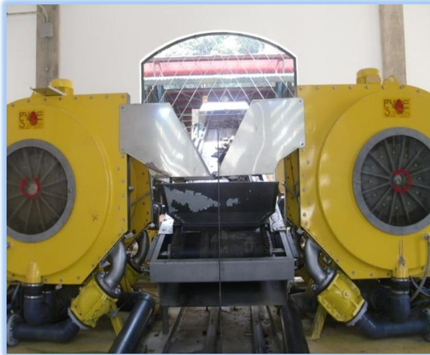
**Figura N° 22. Filtro prensa rotativo**
