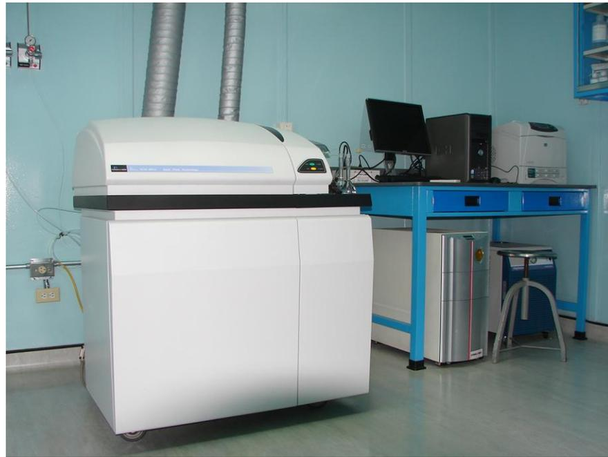
**Figura B2**-Espectrómetro de masa con plasma inductivamente acoplado (ICP-MS). INGEOMIN. Caracas
