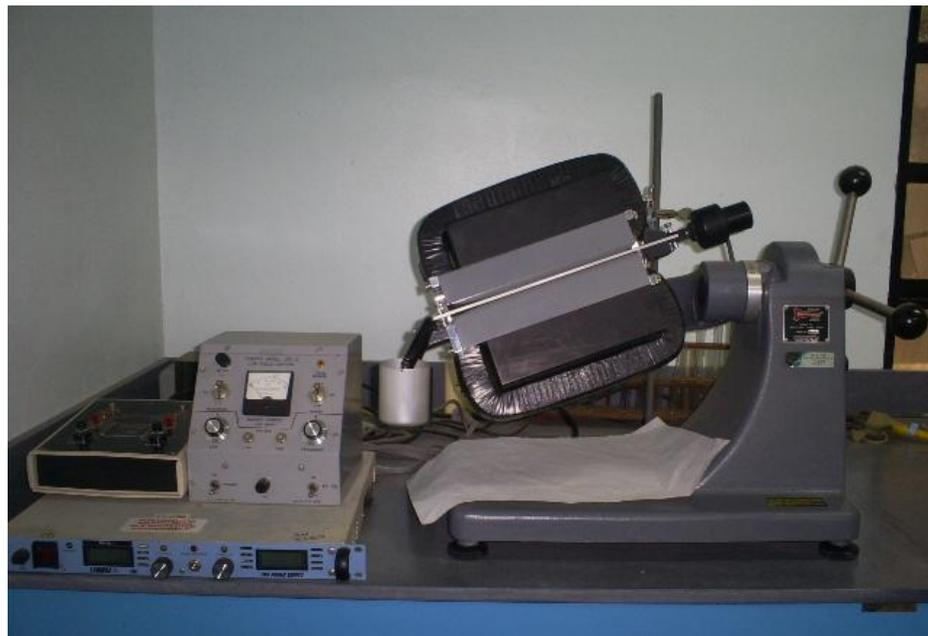
**Figura B3** - Separador isodinámico tipo Frantz. INGEOMIN. Caracas
