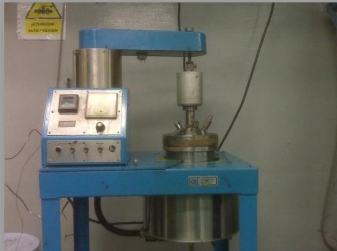
**Figura N° 6:** Reactor por carga (marca Parr)
