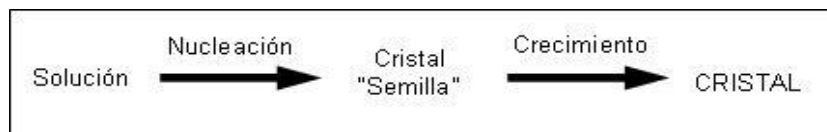
Figura N° 9: Mecanismo de formación de hidratos (Extraído de Marine Desalination Systems, 2009).
