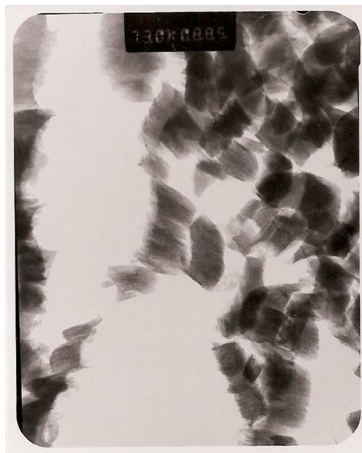
Figura N° 39. MET del carbón activado obtenido por el método III (Aumento 73000X)
