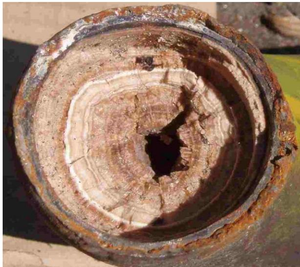
**Figura 1** Tubería con incrustación (Industrias Merus, 2009)
