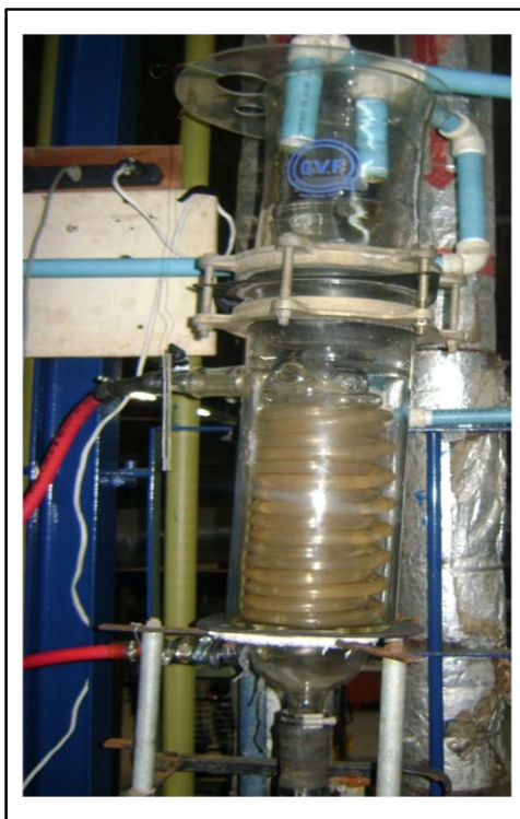
Figura 21. Tanque con serpentín (T-301), contenedor de la solución carbonatada e inhibidor correspondiente (Elaboración propia).
