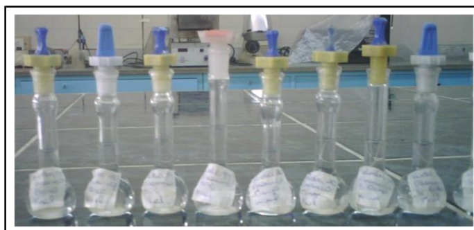
Figura 30. Balones aforados de 10 mL, conteniendo, muestras de solución cálcica para su medición, elaboración propia.
