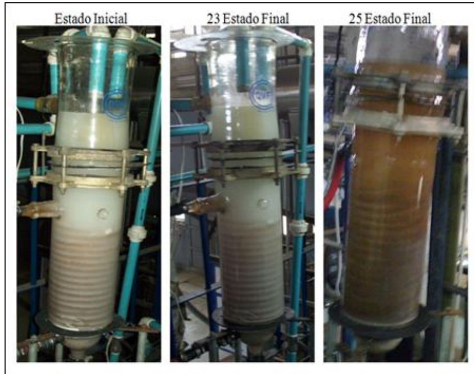
Figura 67. Muestras de agua sintética inicial y final de los ensayos con Tri-fosfato y aloe vera como inhibidor para anillos ya incrustados), elaboración propia.
