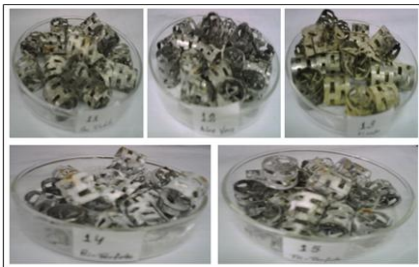
Figura 51. Muestra de los anillos al finalizar las pruebas estáticas con diferentes inhibidores (Aloe Vera, extracto de mango, bi-fosfato y tri-fosfato) y el blanco.
