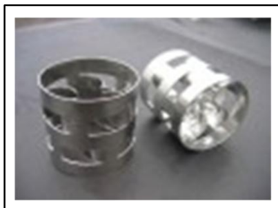
Figura 8. Anillos Pall de 5/8" de acero inoxidable (Elaboración Propia).
