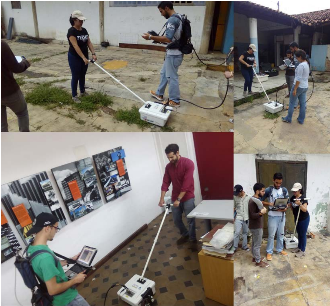
Figura 4.20. Adquisición de datos con la antena de 200 MHz.
