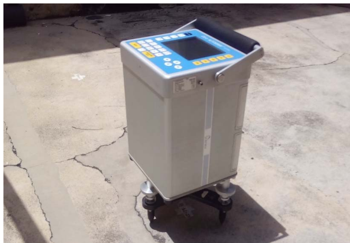
Figura 4.2. Gravímetro CG-5 en funcionamiento.
