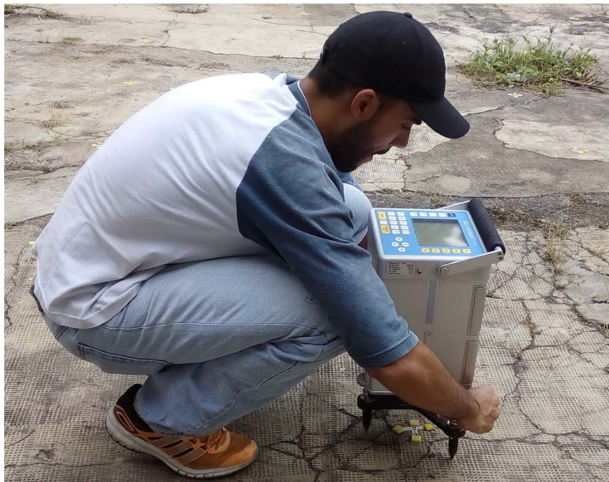
Figura 4.10. Proceso de nivelación del gravímetro CG-5 en campo.
