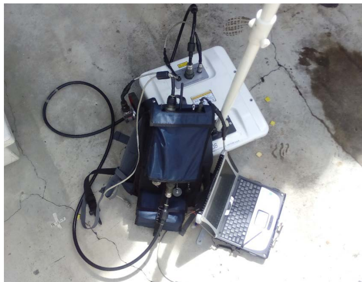
Figura 4.19. Antena de 200 MHz conectada y ensamblada.
