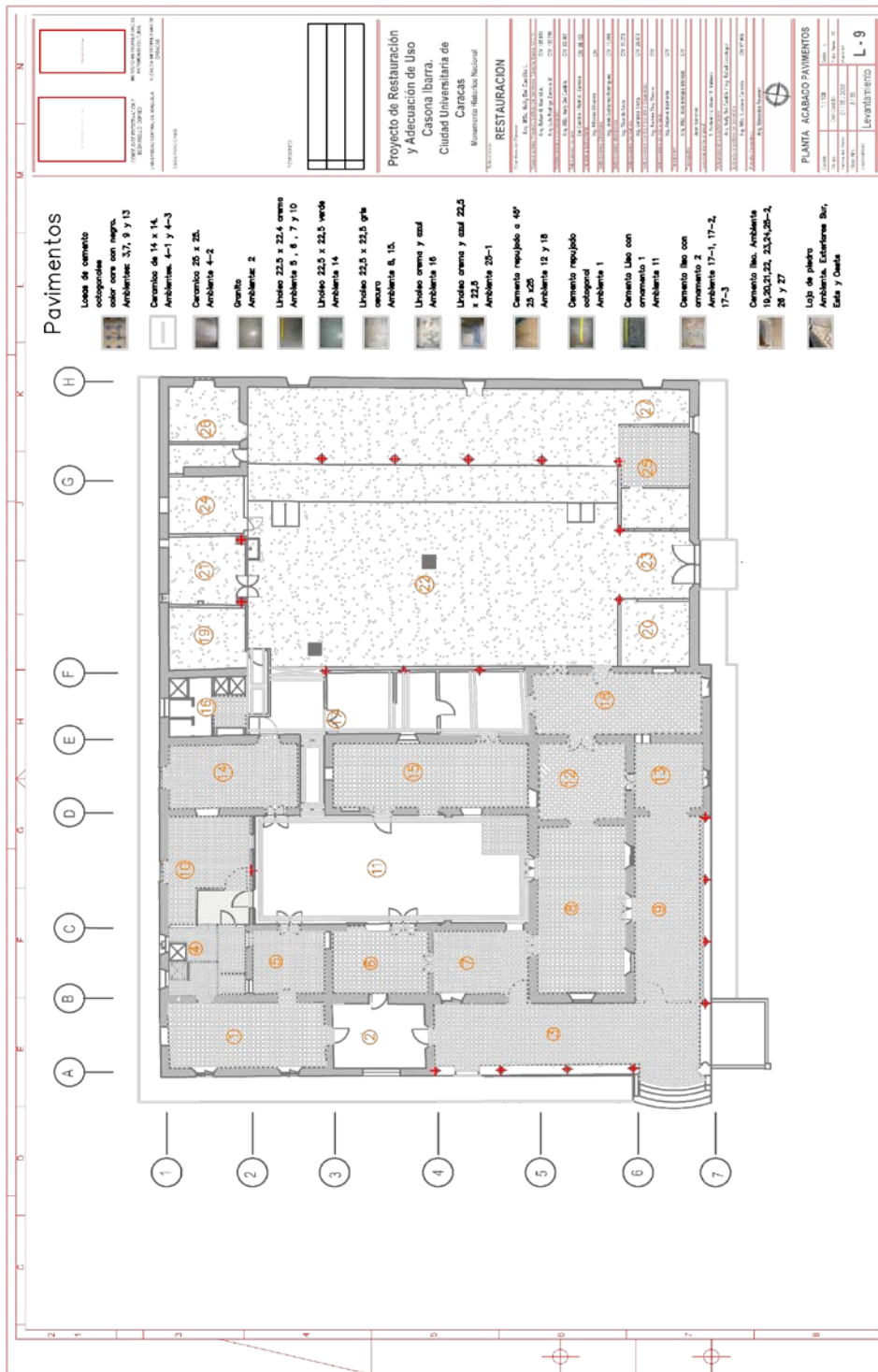
Figura A.2. Planos con los acabados de pisos para la Casona (Del Castillo, 2008).
