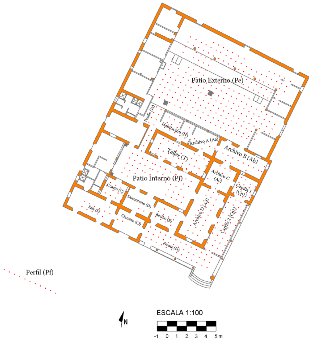
Figura 4.9. Plano de la Casona mostrando los nombres para cada zona y habitación en conjunto con las estaciones levantadas.
