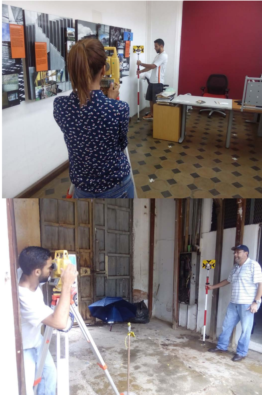
Figura 4.11. Distintas etapas de medición con la estación total.
