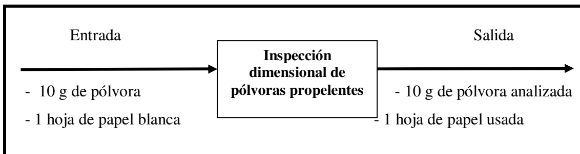
Figura N° 22: Balance de masa de la Inspección Dimensional de Pólvoras Propelentes.
