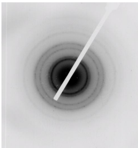
Figura 3.102. Patrón de difracción de electrones obtenido para las nanopartículas de RhCo sintetizadas a -1,25 V/ENH, y la tabla comparativa entre distancias experimentales y las reportadas en la JPDS-ICDD.
