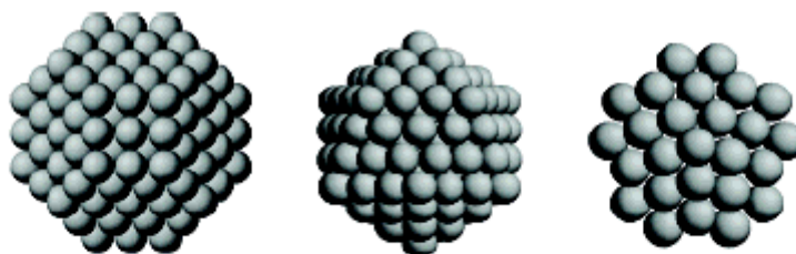
Figura 1.9. Diferentes estructuras cristalinas octaedro truncado, icosaedro y decaedro truncado.
