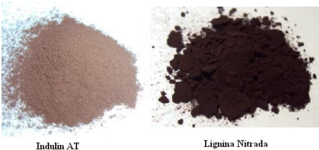
**Figura N°14.** Diferencia entre el color del Indulin AT y la lignina nitrada
