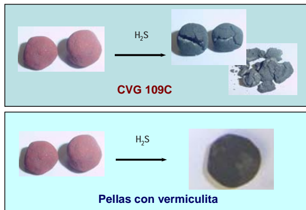
Figura 12. Estado final observado en las pellas preparadas de forma manual con vermiculita y las CVG-109C, luego de la reacción con H 2 S
