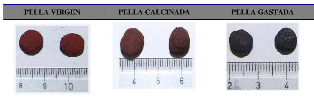
Figura 16. Apariencia física de las pellas P-202a (virgen, calcinada y gastada)
