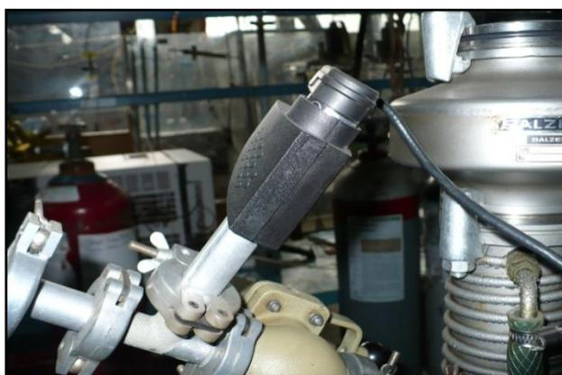
*Figura N° 13 Sensor de bajo vacío*
