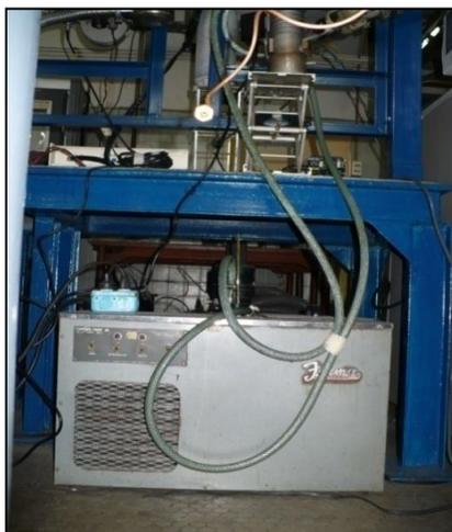
*Figura N°14 Sistema de enfriamiento*
