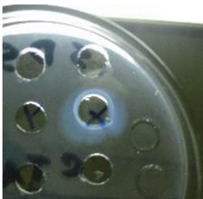
Anexo XX. Resultados en la doble difusión con agar (ADD) para determinar la carga iónica del biosurfactante. Los pocillos superiores están cubiertos con solución de SDS a 0,5g/l, mientras que los pocillos inferiores están cubiertos de una solución de CTAB 0,5g/l. En los pocillos del centro están las muestras de los biosurfactantes producidos por las cepas MN3-4 (pocillo del centro a la derecha, sobre la X) y la cepa MN3-1 (pocillo del centro a la izquierda, sobre la Y). El biosurfactante producido por la cepa MN3-4 es de carga aniónica, y en presencia de SDS precipitara y formara un precipitado (halo difuso alrededor del pocillo) orientado hacia su carga opuesta, mientras que en presencia de CTAB, su misma carga se repelerá. En el caso de la cepa MN3-1, esta al no presentar carga iónica no responderá a ninguno de los dos surfactantes y no formara precipitado.
