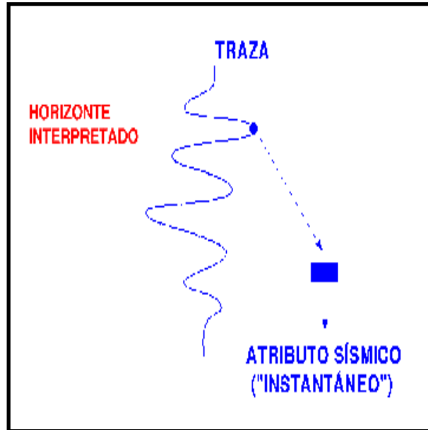
Figura 5.2. Representación del atributo sísmico instantáneo en la traza sísmica (tomado de Briceño et al., 1999)..
